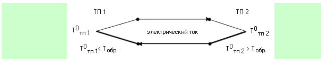
Где:  $T_{обр}$  – температура обращения (температура инверсии  $T_i$ ), при которой коэффициент Пельтье изменяет свой знак с ростом температуры; ТП 1 и ТП 2 – два блока термопар с радиаторами.
